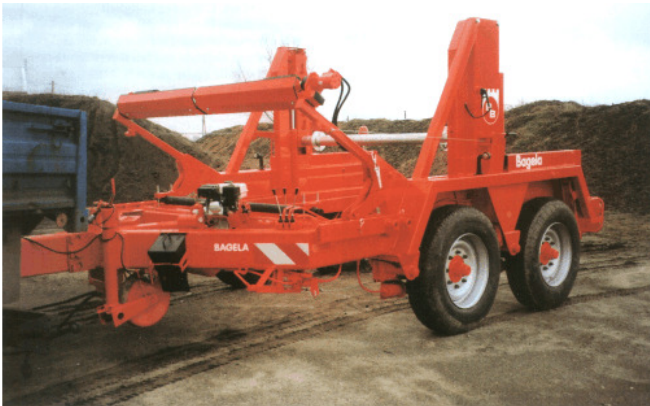
BTT 140.25 mit motorhydraulischer Trommelantrieb- und Hubeinrichtung
