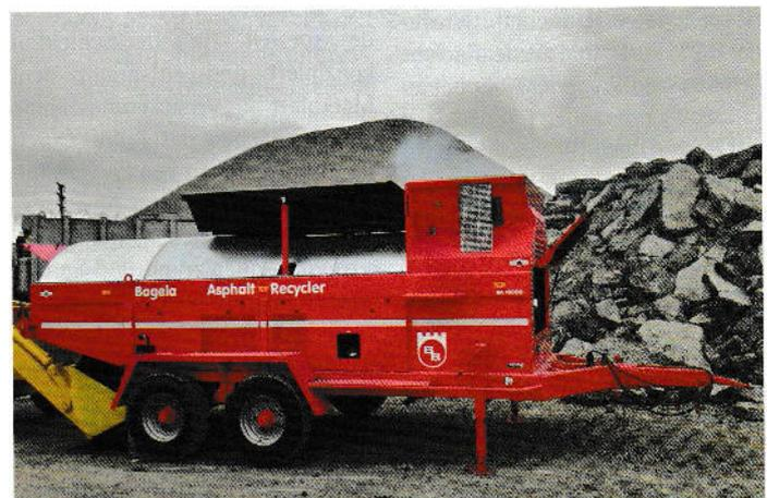
Bild 2: Mit dem Asphaltrecycler kann Asphaltaufbruch oder auch Fräsgut verarbeitet werden
