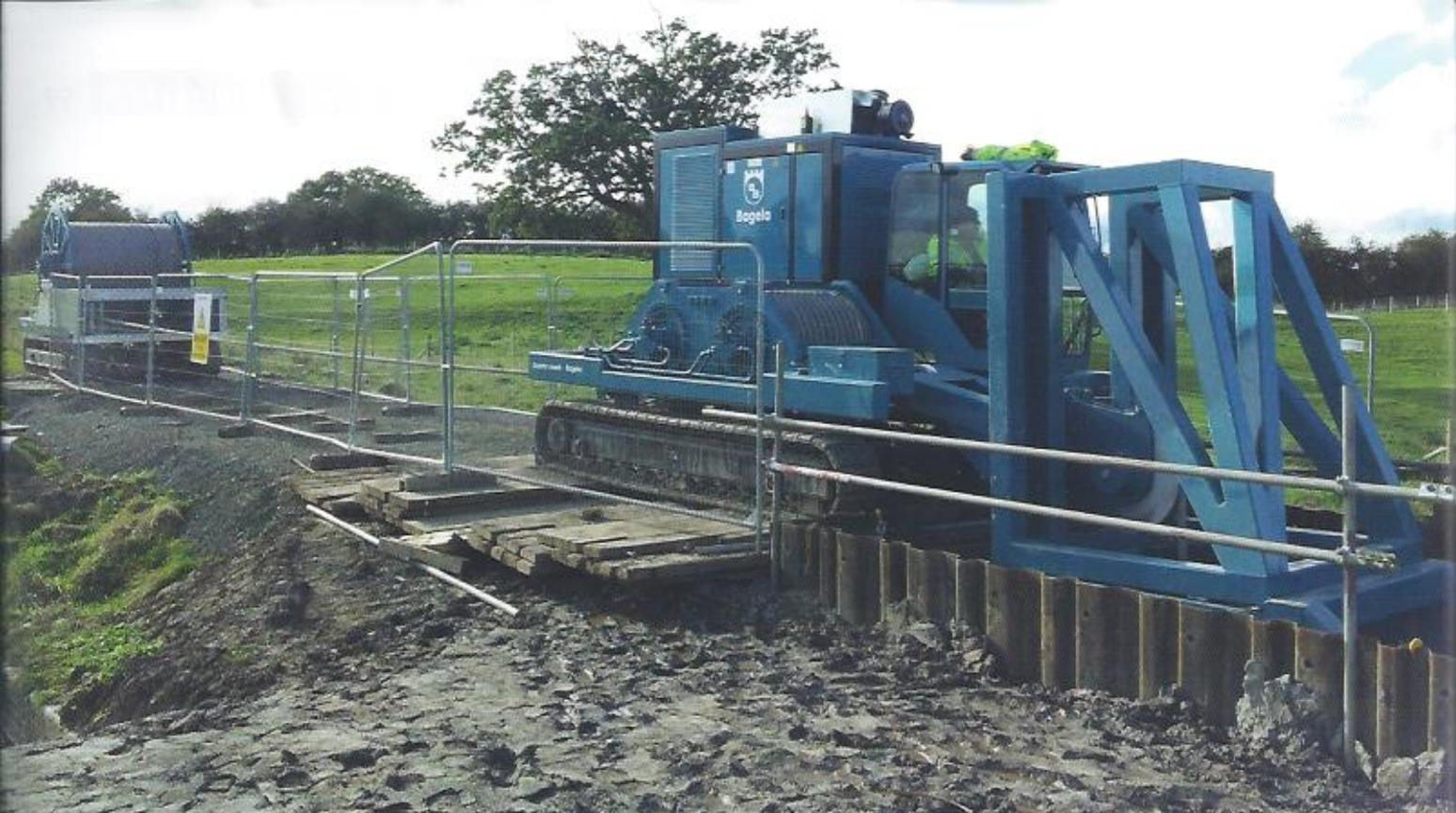
Die neue Rohrspannungswinde mit einer Zugkraft von 100 t im Baustelleneinsatz in Großbritannien.
