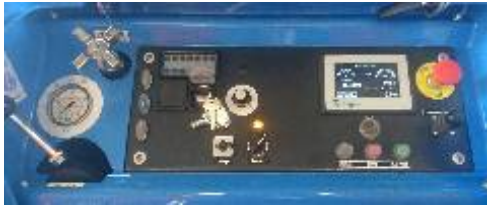
Winchensteuerung mit PC 310
