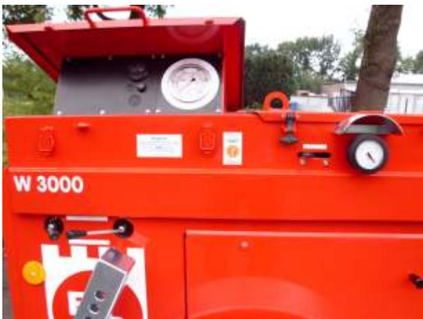
Ein Zugkraftbegrenzungsventil unterbricht den Einzugvorgang sobald die vorgewählte Zugkraft erreicht ist. Während des Zugvorgangs wird die aktuelle Zugkraft über eine Messuhr angezeigt.
