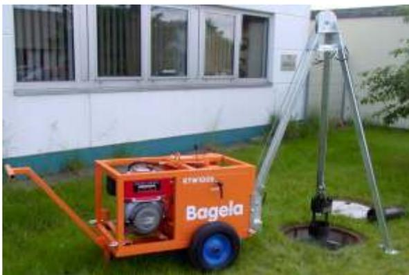
KTW 1005 mit Transporträdern, Deichsel, automatischer Seilschichtung und Dreibock (Sonderzubehör) in der Rohrreinigung.
