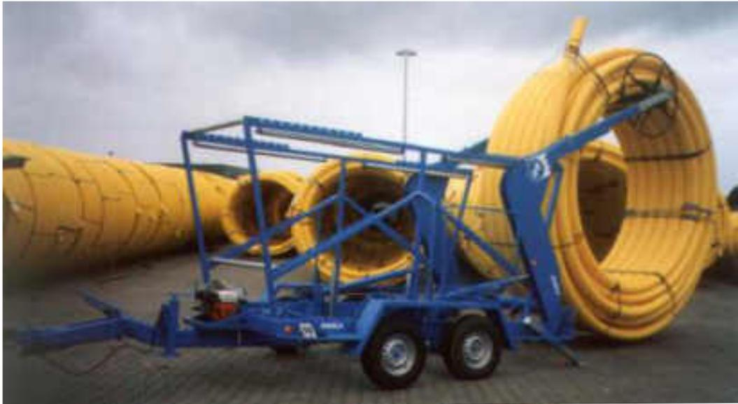
Der BRT 20 kann liegende Rohrbunde ohne fremde Hilfe aufnehmen, einladen und abspulen. Mit Hilfe der senkrechten, hydraulischen Stützenträger werden die Rohrbunde unterschiedlicher Durchmesser auf die unteren Tragrollen abgesenkt. Danach werden drei innere Führungsrollen eingesetzt und mit Klappsplinten gesichert, das Rohrbund ist abspulbereit.
