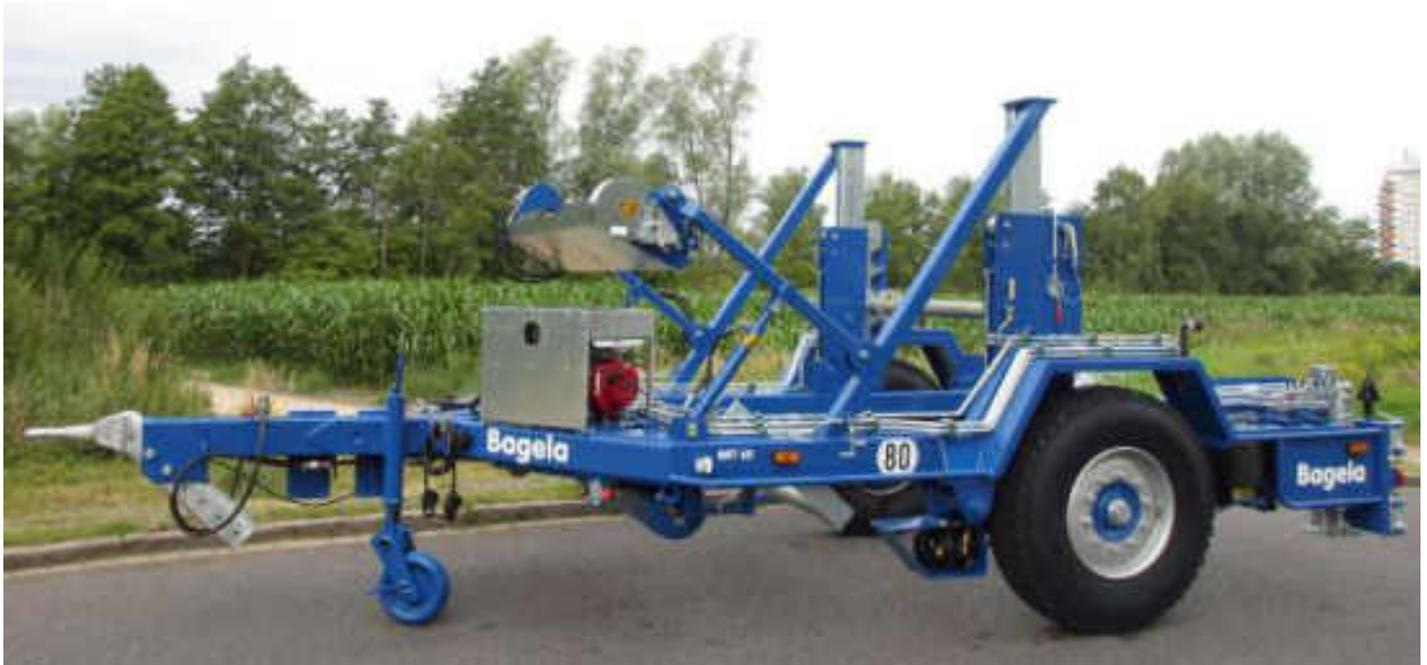
Um "Compact-Pipe" Inliner von 400 mm Rohrdurchmesser noch wickeln zu können, benötigt man Rohrtrommeln mit einem Außendurchmesser von 3700 mm. Für diese Anforderungen wurde der BRT 65 in nach hinten offener Bauweise gefertigt, die ein direktes Platzieren der Rohrtrommel in den Wagen ermöglicht. Serienmäßig wird der Anhänger mit einer - zur Seite klappbaren - Heckpforte ausgestattet.
