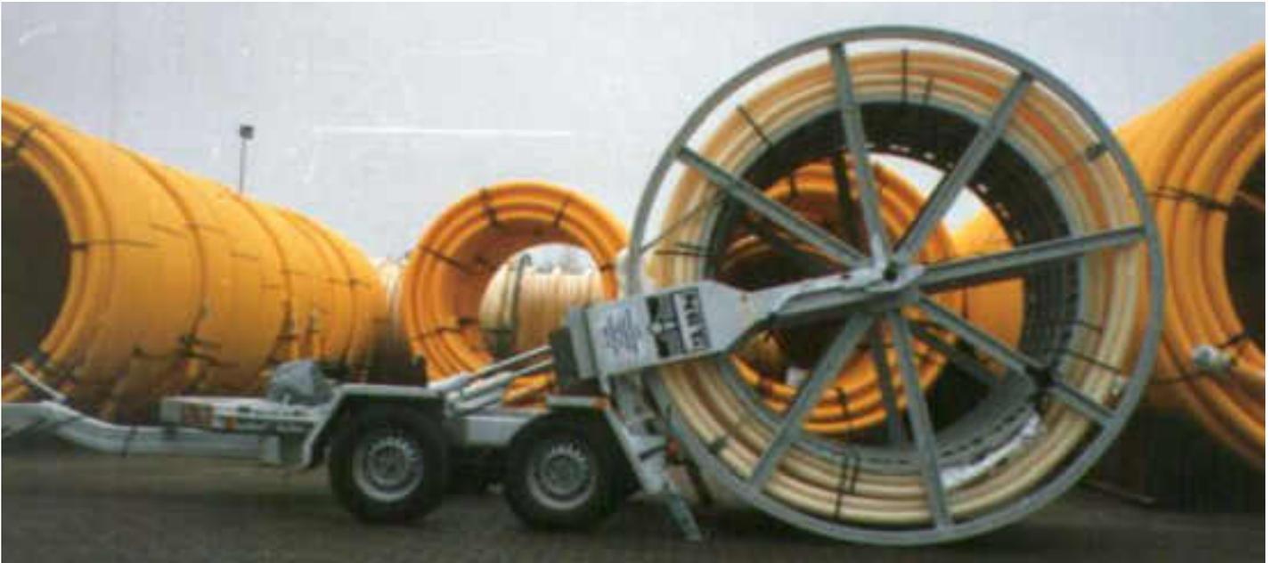
**BRT 25 beim Aufnehmen einer U-Liner-Rohrtrommel**
