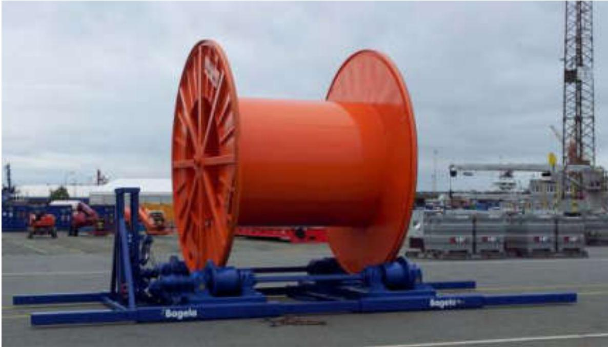
Mit diesem Gerät können Restkabelängen aus einem Seekabelleger gezogen und auf Trommeln bis zu 80 t Gesamtgewicht aufgespult werden. Die Trommeln werden fest mit den Antriebswalzen verspannt. Es wird eine Zug- und Bremskraft, abhängig vom Trommeldurchmesser, von bis zu 110 kN erreicht.
